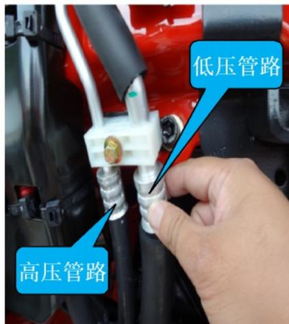
低压管路触摸应感觉冰凉，如果感觉常温或烫手，表明空调不制冷或制冷效果不好。
